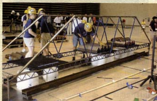
写真-5 鉛直方向の載荷試験 (3個所の床版上にL型鋼を載せて直下のたわみを計測)
