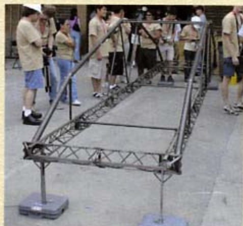
写真-6 橋の重さの計量(4つの秤を利用)
